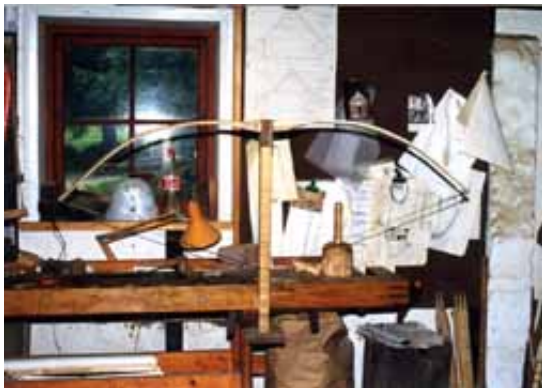
Tillerstok til venstre og tiller med taljetræk til højre.
